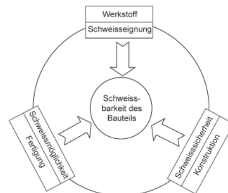
Bild 2-1. Schweißbarkeit von Bauteilen nach DIN-Fachbericht ISO/TR 581.
