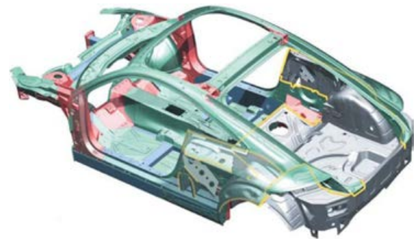
Bild 2. Verklebung Stahl- und Aluminiumteile.
