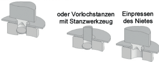
Bild 3. Prinzipdarstellung der Halbhohlniet-Vormontierung.
