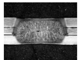
Bild 1b. Dreiblech-Punktschweißung: TRIP700, Dicke 1,2 mm, CP800, Dicke 1,0 mm, CP800, Dicke 1,4 mm.
