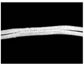
Bild 1e. Rollennahtschweißung, Überlappnaht – quer; links: Überlappnaht an rostfreier Folie X5CrNi18 9 von 2 x 0,07 mm Dicke; rechts: Konturnaht an einem Auto-Kraftstoffbehälter, geschweißt mit Drahtzwischenelektrode.
