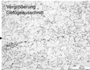
Bild 1d. Rollennahtschweißung, Quetschnaht: DC06, Bandanbindung, Inspektionslinie; Dicke 1,2 mm, Schweißung mit geringerer Überlappung: keine oder geringe Nahtüberhöhung.
